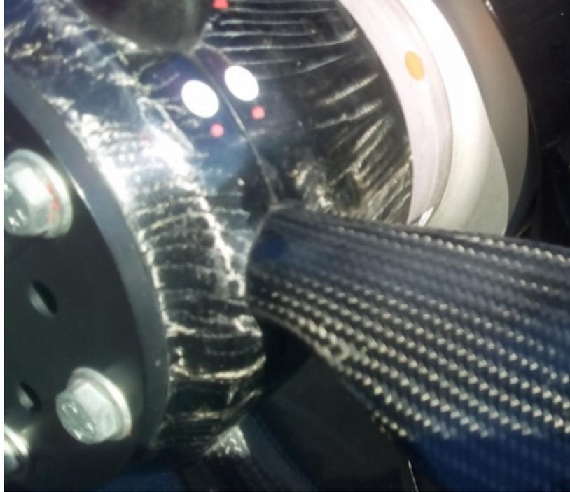
Les rondelles frein ne sont pas adaptées au montage E-PROPS. Elles ne résistent pas aussi bien aux vibrations que les Nord-Lock, et leur épaisseur n'est la même que celle des Nord-Lock, ce qui modifie tout le montage et ne permet pas d'assurer correctement le serrage.
