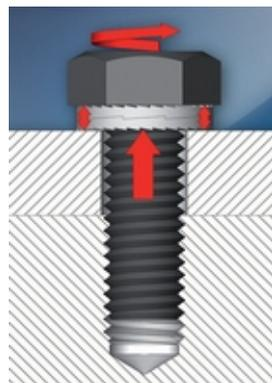
Les Nord-Lock® en version Acier sont efficaces jusqu'à 200°C. Ces rondelles ne sont aucunement affectées par les lubrifiants. Elles sont réutilisables jusqu'à environ 50 fois (selon contrôle visuel de l'état). Elles peuvent être utilisées avec tout type de vis.
