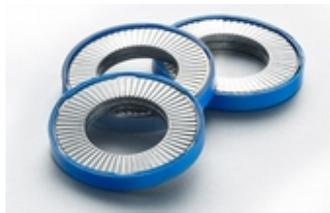
Ce système est composé de deux rondelles : l'une des faces possède des cames, l'autre face une denture radiale. Utilisées impérativement par paires (il ne faut jamais les démonter), leur fonctionnement dépend des angles de came de surface qui sont supérieurs à l'angle d'hélice de filetage des boulons avec lesquels elles sont utilisées.
