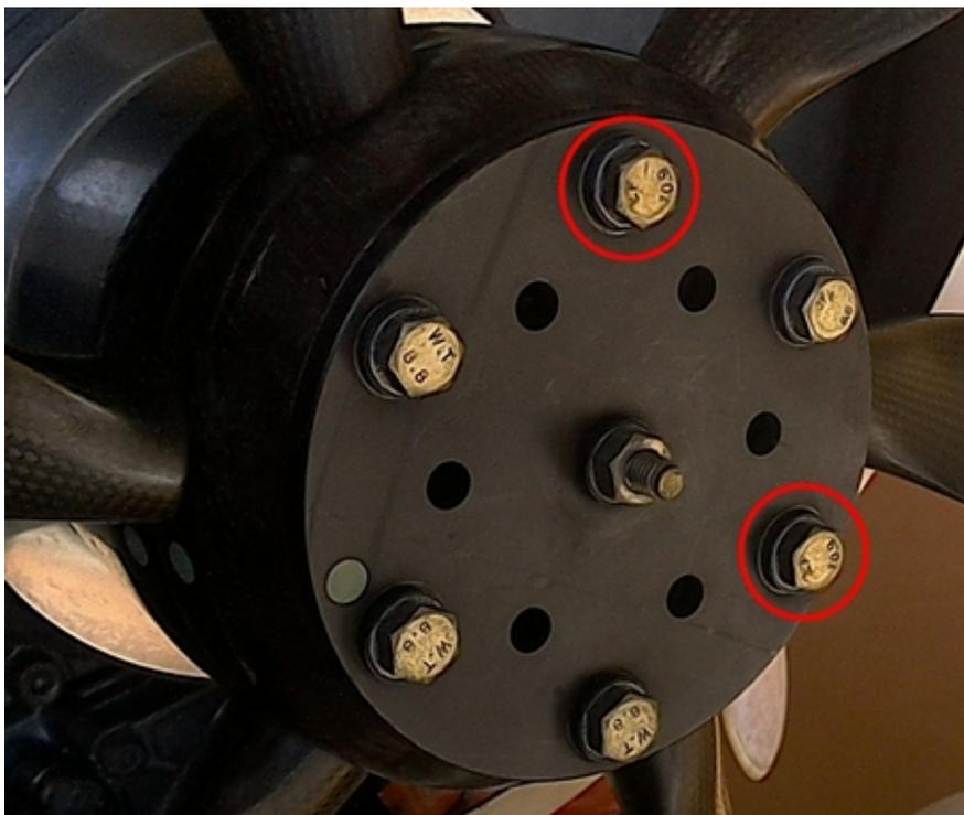
Remplacer des vis 10.9 par des vis 8.8 réduit de 40% la résistance mécanique du système de fixation. Les vis 8.8 et 10.9 n'ont pas la même résistance élastique et ne doivent pas être serrées au même couple (voir explications détaillées dans la suite du présent document).
