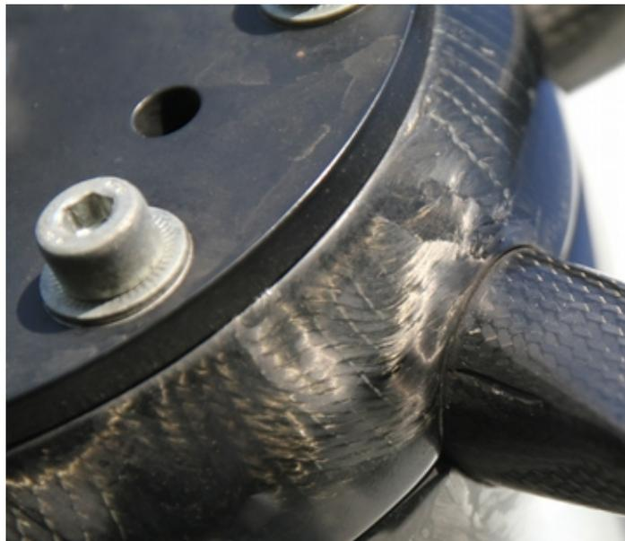
Depuis la mise sur le marché de ce modèle d'hélice EXCALIBUR-6, soit début 2016, E-PROPS impose des vis Acier de qualité 10.9 et des rondelles anti-desserrage Nord-Lock pour le montage, et ceci pour des raisons techniques précises (voir explications détaillées dans la suite du présent document).
