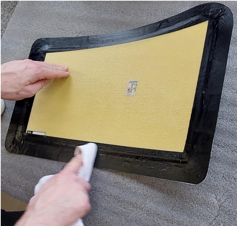
Figure. 3 Polissage du séparateur
