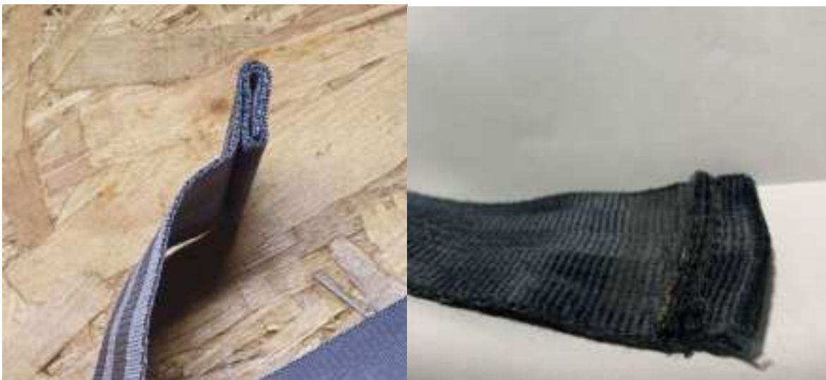
Figure 9 : détail des sangles textiles et ourlet : à gauche, sangle Anjou Aéro, à droite sangle montée sur l'ULM Air Création (Source : Anjou Aéro/BEA)
