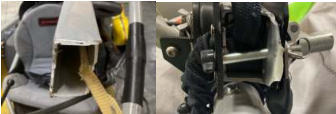
Figure 6 : faciès de rupture de la poutre supérieure : à gauche côté tricycle avec la sangle, à droite côté aile (Source : BEA)
