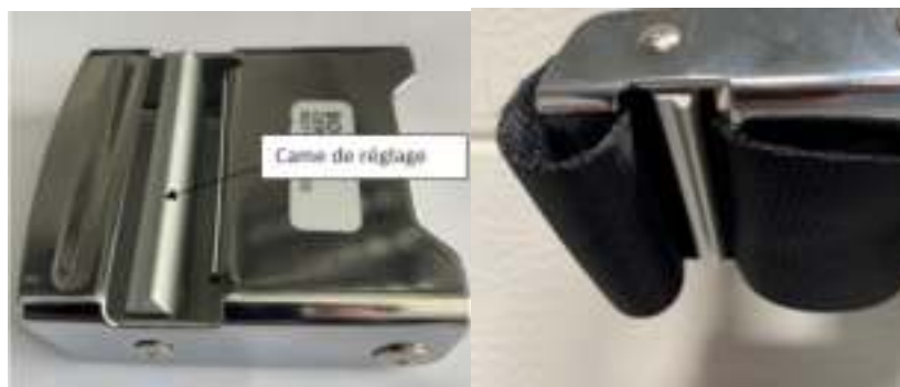
Figure 7 : boucle métallique femelle de la ceinture ventrale de la passagère (Source : BEA)
